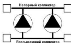
Расположение напорных/всасывающих коллекторов и резиновых компенсаторов\* (отметить нужное) (комплект учтены 2 резиновых компенсатора и 2 заглушки)
